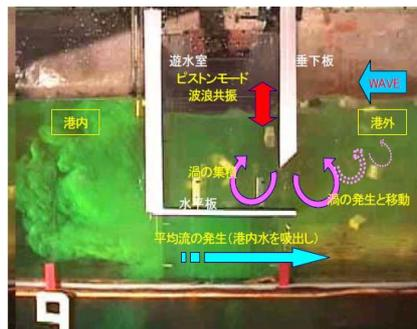
波の力を利用して底層流を発生させ、汚れた海水を吸引し閉鎖性水域における海水交換を促進します。
