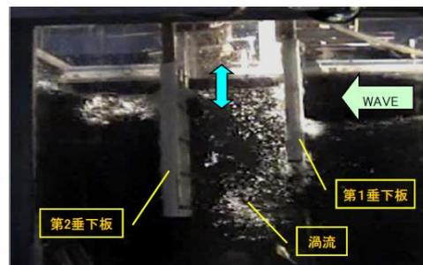
垂下板を2枚にしたり、スリットケーソンと組み合わせることで幅広い周期の波に対応可能です。直立消波護岸としての利用のほか、栈橋式岸壁に垂下板を取り付けるだけで環境共生型の岸壁を実現できます。生物着生層との組み合わせも有効です。
