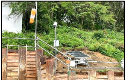
▲ソーラー式定点カメラの設置
