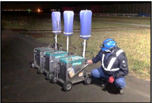
▲バッテリー式LEDバルーン投光器
