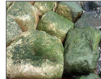
この工事では、生物の環境を守るために基礎捨石及び被覆石はJFEスチール(株)製の鉄鋼ラグ水和固化体製人工石材『フロンティアロック』を使用して施工を行いました。この材料は、通常の自然石と異なり、表面が粗面で藻類が着きやすいと考えられています。
